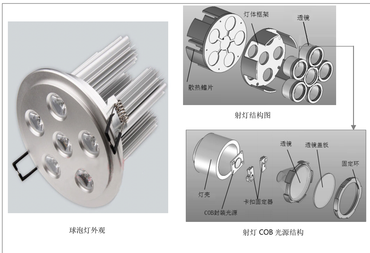
图 4 COB LED 射灯示意图及结构图
